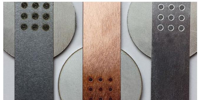
Unabhängig von Material, Dicke oder der Kombination unterschiedlicher Metalle können eine Vielzahl an Produkten geschweißt werden. Mit dem Kurzpuls-Schweißverfahren können Kombinationen dünner metallischer Bauteile verbunden werden. Dazu zählen auch hochreflektierende und leitfähige Metalle – perfekt für Anwendungen wie das Schweißen von Batterien.
