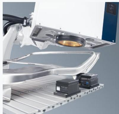
Besonders bei hohen Genauigkeitsanforderungen wie hier beim Laser-Remote-Schweißen profitieren Sie von einer automatischen Überprüfung und Kalibrierung des Werkzeugs.
