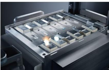
Schweißen von Aluminium-Batteriegehäusen mit der PFO.
