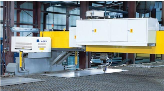
Den stabilen Resonator können Sie sogar auf bewegten Brücken installieren.
