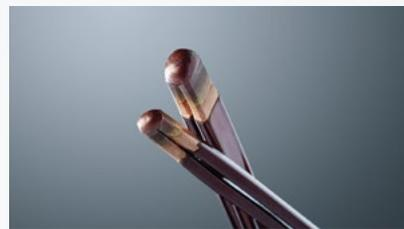
Eine Anwendung für die Bildverarbeitung ist die Positionserkennung von Hairpins in Statorn von elektrischen Motoren.
