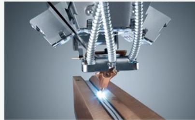
Die Nahtlageregelung reduziert Ihren Ausschuss auf ein Minimum, zum Beispiel beim Schweißen von Rohren und Profilen.
