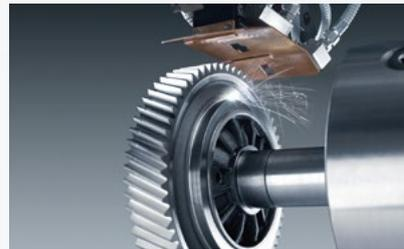
Beim Schweißen von Getriebeteilen sind zusätzliche autarke X- und Z-Achsen in die hochpräzise Nahtlageregelung integriert.
