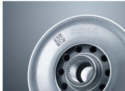
Data Matrix Code (DMC) und Klartext für dauerhafte Rückverfolgbarkeit in der Serienproduktion.
