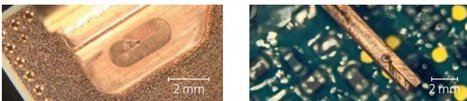
Kontrollierte Einschweißtiefen beim Schweißen von Kupferkontakten auf DCB-Substrat mit dem TruDisk 1020.
